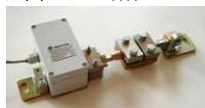
**Рис. 4. Индукционный датчик перемещения СМД-ДП-2**
