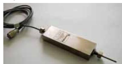
**Рис. 3. Измеритель угла наклона ИУН2-1**
